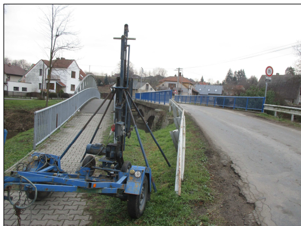
foto 3: Realizace dynamické penetrační zkoušky DP2
